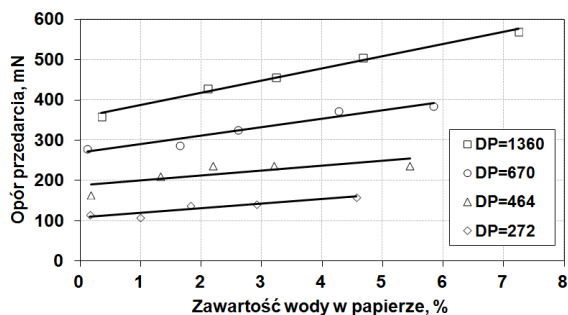
Rys. 4.20. Opór przedarcia w kierunku poprzecznym włókien w zależności od zawartości wody przy różnych stopniach polimeryzacji celulozy [A2]
