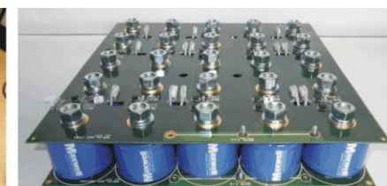
Zasilacz dużej mocy z podtrzymaniem napięcia wyjściowego po zaniku zasilania i moduł super-kondensatorów (16 F/60 V) z systemem BMS
