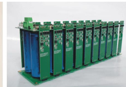
Zasilacz typu UPS do zastosowań o szczególnych narażeniach środowiskowych - wraz z modułem baterii Li-ION i systemem BMS
